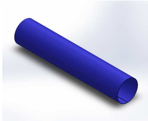
Slika 4.14. 3D model izolacije oko cilindra - tesnit
