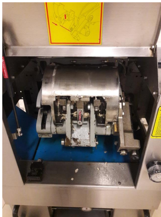
Slika7.28. Rotacijska komora za mjerenje težine komada
