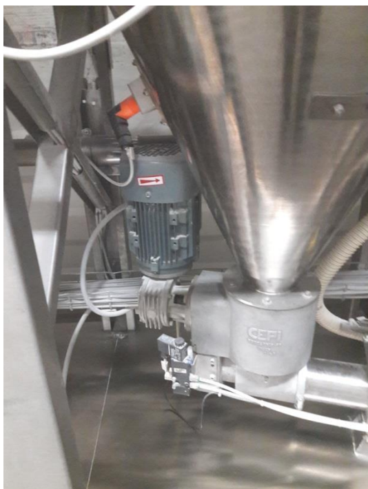
Slika 7.4. Dozator silosa sa aditivima
