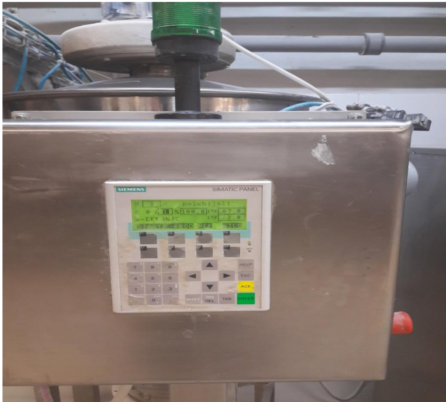
Slika7.12. Kontrolni panel na dozirnem mjestu
