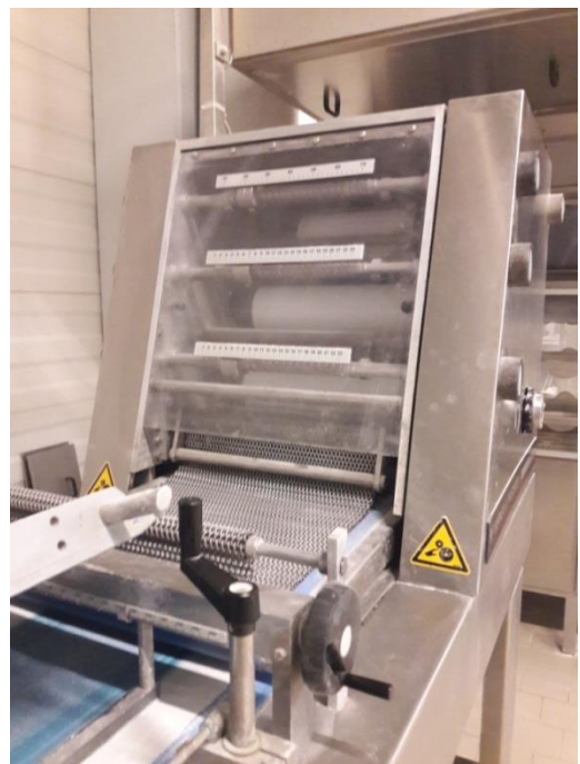
Slika7.34. Valjci za oblikovanje i mehanizmi
