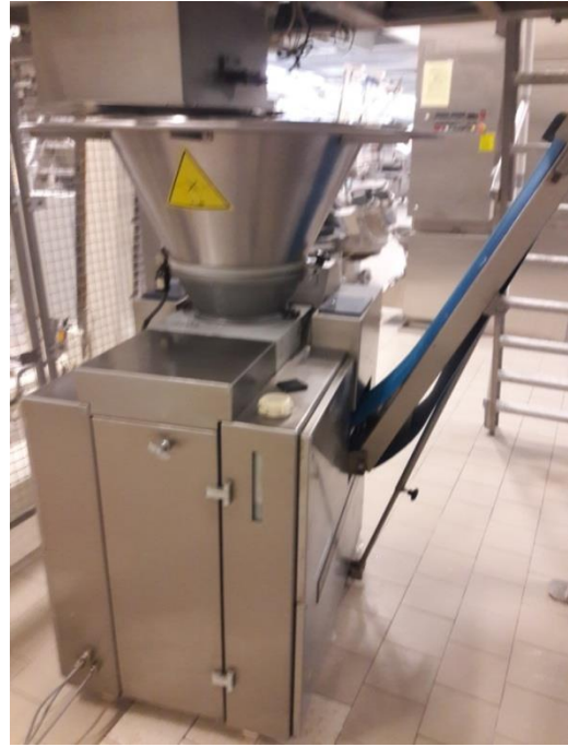
Slika 7.26. Dijelilica tijesta i pripadajuća transportna traka
