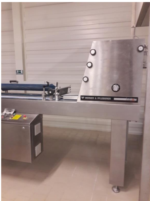
Slika 7.33. Stroj za savijanje tijesta za podešavanje debljine tijesta
