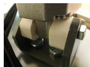
d) Fotografija revolucijskog zgloba s odstojnikom
