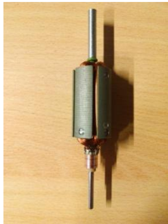
b) Stezni spoj spojke i osovine rotora
