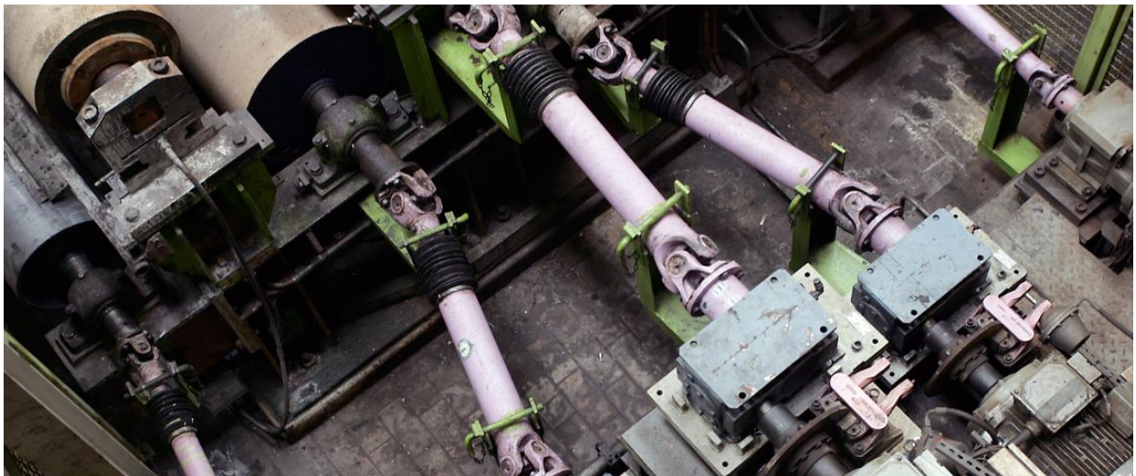
Slika 12.3. Korištenje kardanskih vratila za spajanje elektromotora i valjaka u pogonu za proizvodnju papira [7]
