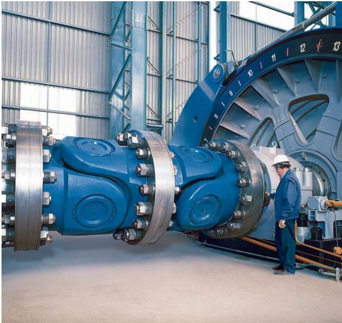
Slika 12.4. Upotreba kardanskog vratila u hidroelektranama [8]
