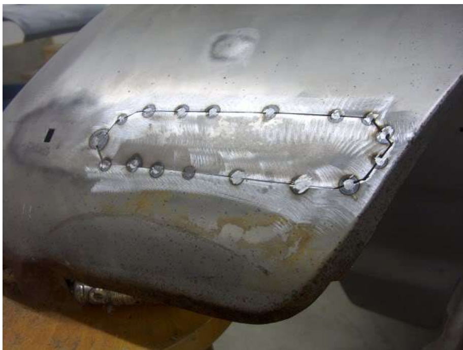
Slika 6.1. Točkasto zavareni spoj [8]
