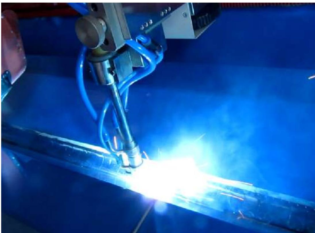
Slika 6.7. Zavarivanje MAG postupkom [14]
