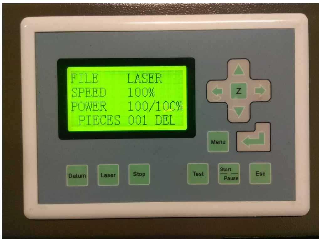
Slika 5.1. Upravljačko sučelje PAD03 tipkovnica i LCD zaslon
