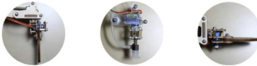
Slika 6.2. Hvataljka pogonjena malim servo motorom, sisaljka pogonjena vakuumskom pumpom i hvataljka postavljena vertikalno [19]
