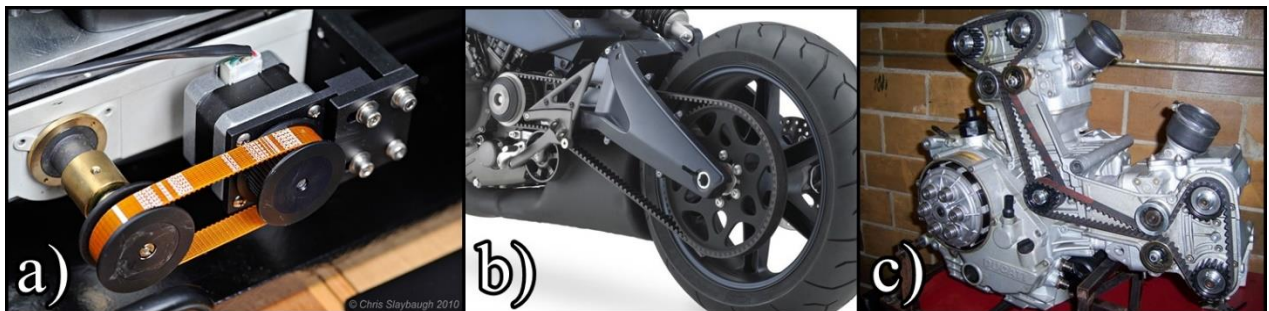
Slika 4.15. Primjeri korištenja zupčastog remena, a) prijenos vrtnje sa step motora; b) završni prijenos motocikala c) razvod bregastih vratila kod Ducati motocikala. [25, 26, 27]
