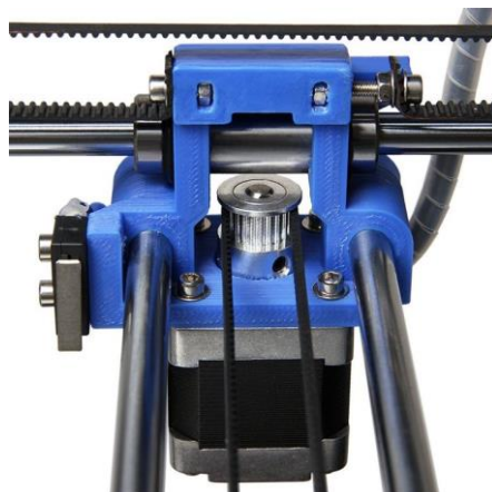
Slika 8.4. Linearni aktuator izveden zupčastim remenom [61]
