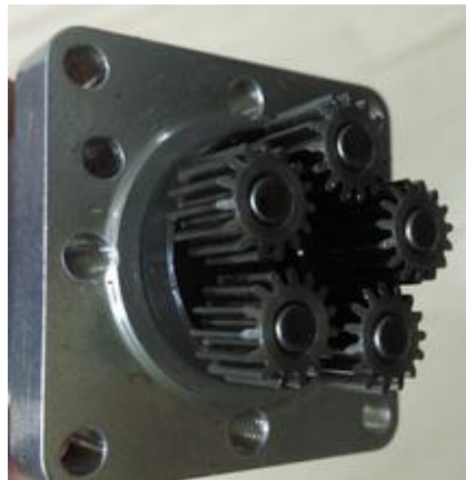
Slika 8.3. Planetarni prijenosnik robotske ruke [60]
