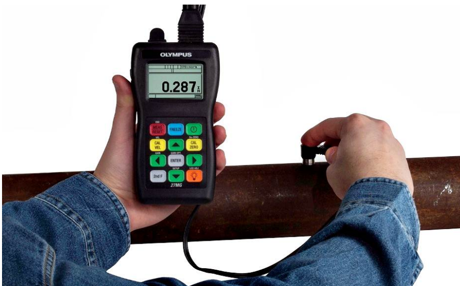
Slika 2.5. Mjerenje debljine stijenke [12]
