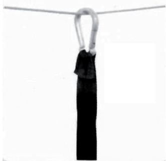
Slika 1. Ovalna kukica na čvrsto uporište
