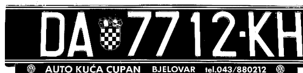
Slika 6. Slika registarske pločice nakon binarnoga ograničavanja i invertiranja slike
