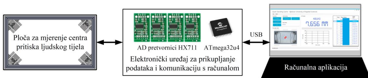
Slika 2.1: Blokovska shema mehatroničkog sustava za procjenu ravnoteže ljudskog tijela
