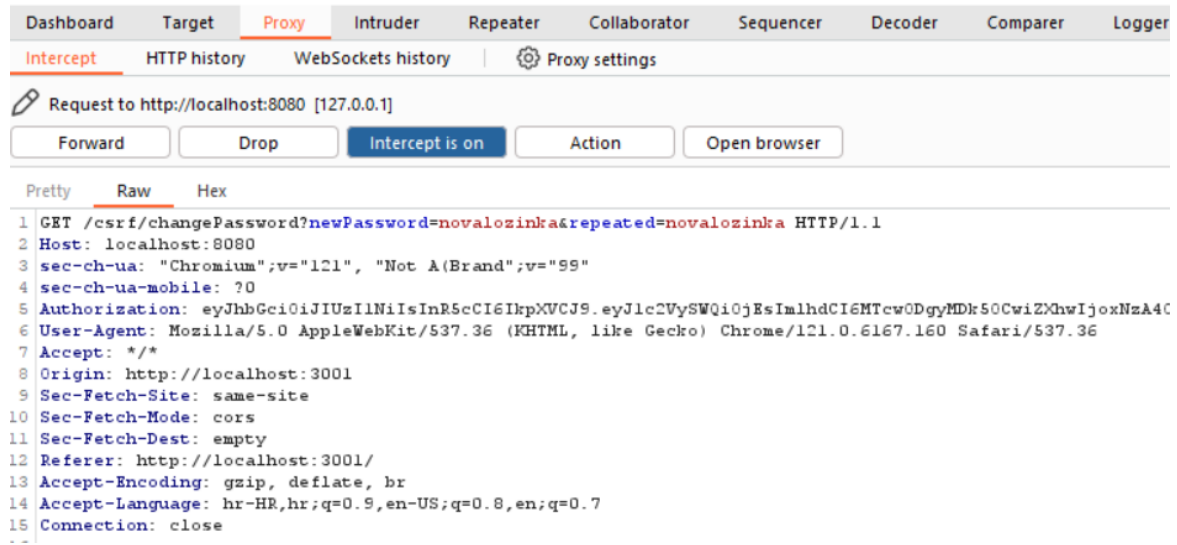
Slika 6.22: HTTP GET zahtjev s podacima za promjenu lozinke
