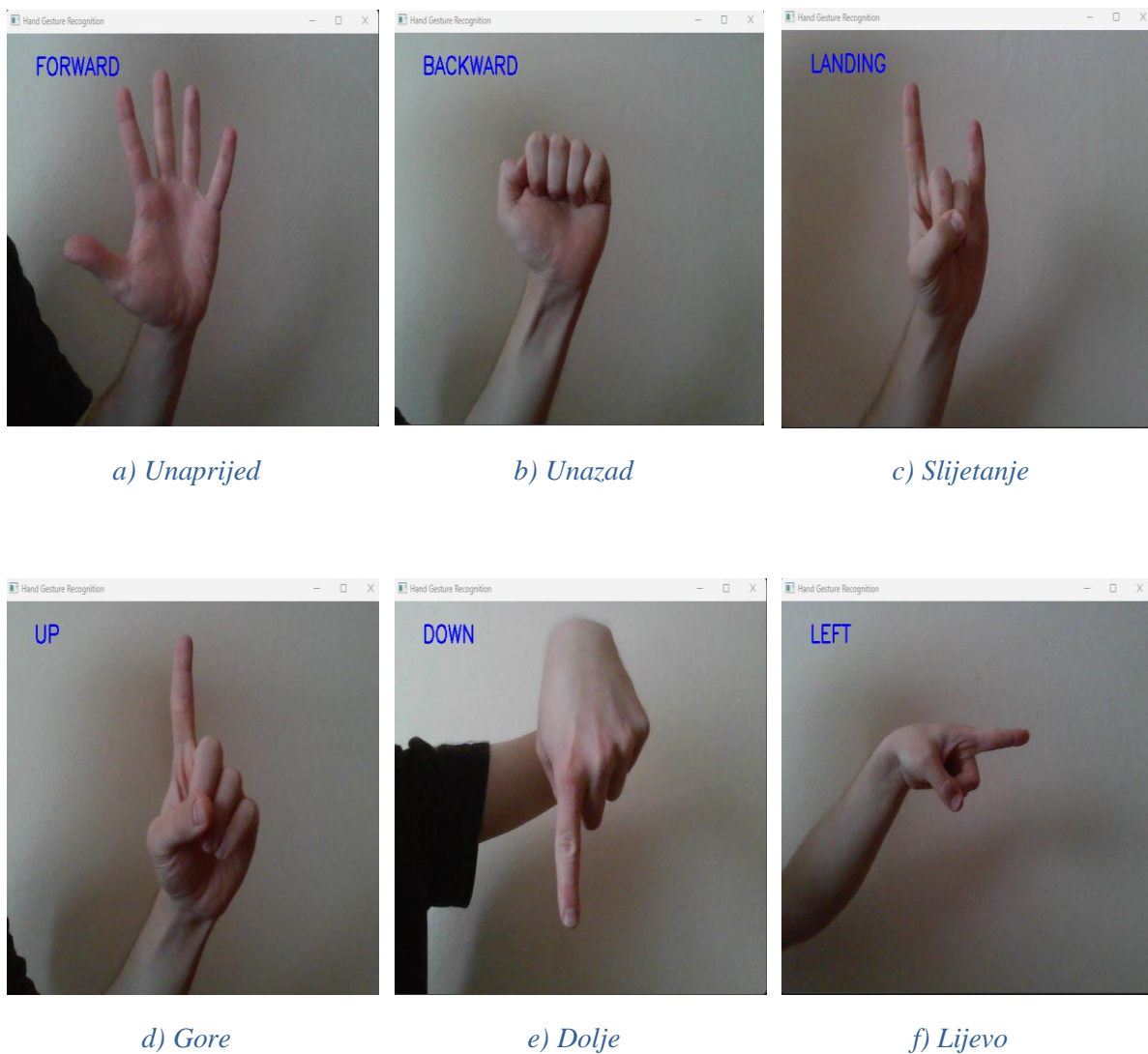
Slika 4.8: Primjer upravljanja letjelice pomoću gestikulacija rukama
