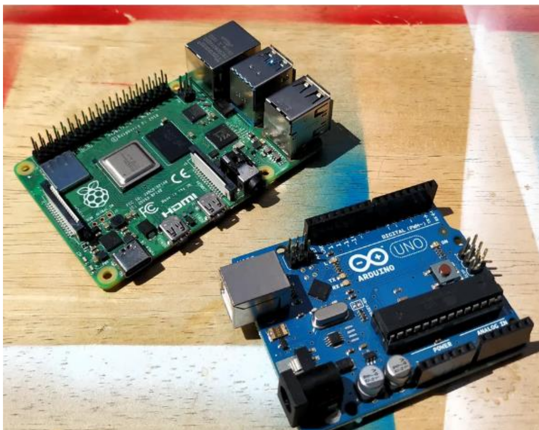
Slika 3.9: Razlika između razvojnih okolina Arduino i Raspberry Pi [16]
