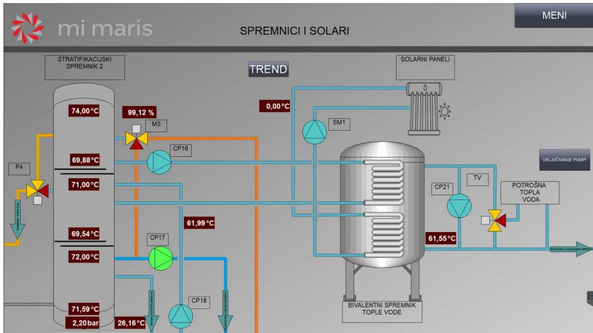
Slika 4.9 Prozor drugog stratifikacijskog spremnika i sustava solarnih kolektora
