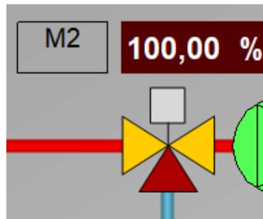
Slika 3.2 Primjer grafičkog prikaza analogne otvorenosti miješajućeg ventila
