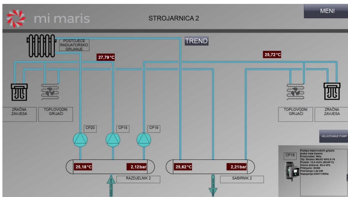
Slika 4.11 Prozor strojarnice hale kamina i dimovoda
