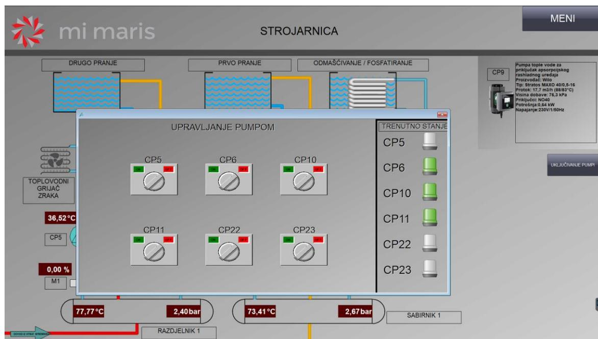
Slika 5.3 Prikaz prozora za uključivanje pumpi prozora strojarnice
