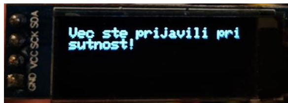
Slika 5.4: Prikaz na OLED zaslonu nakon ponovnog pokušaja prijave prisutnosti
