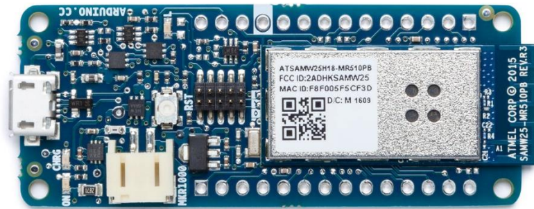
Slika 3.11: Prikaz Arduino MKR1000 razvojnog okruženja [20]
