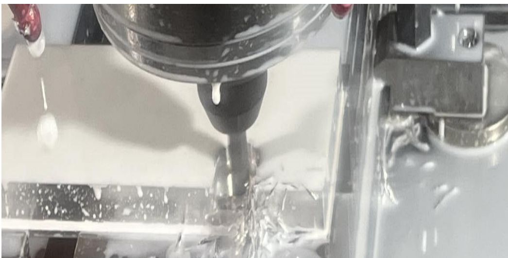
Slika 9.2: Gruba obrada vanjske konture i džepa sa glodalom promjera 10 mm
