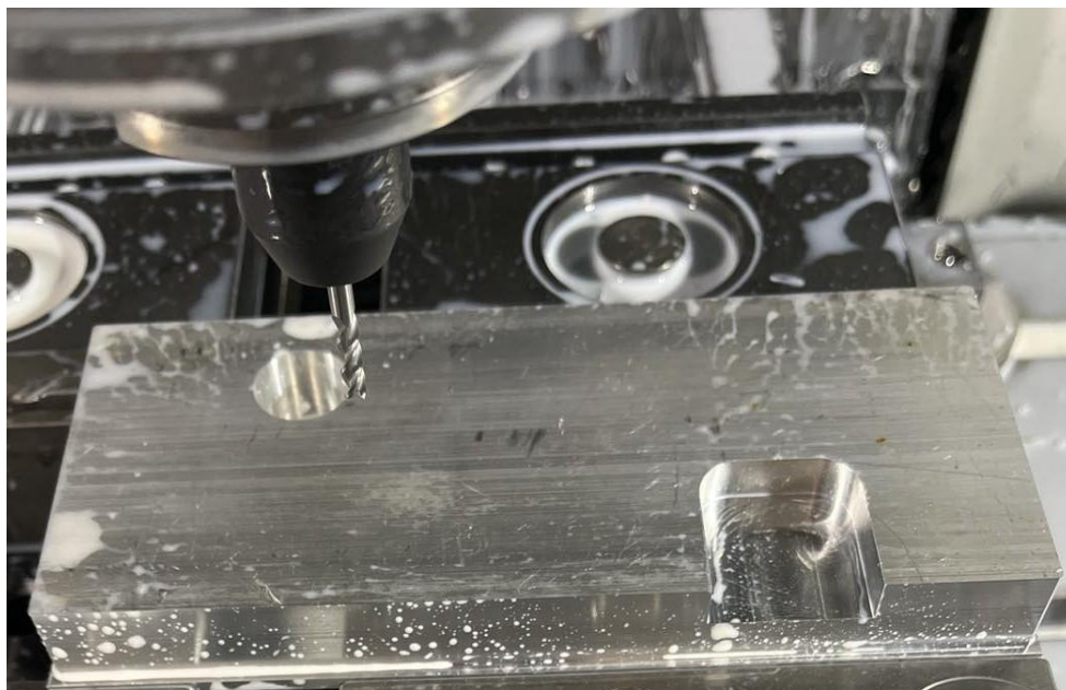
Slika 9.4: Operacija glodanja rupe promjera 20 mm sa glodalom promjera 8 mm
