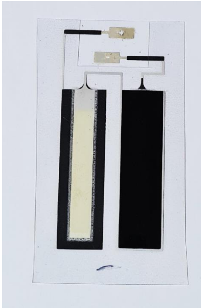
Slika 3.3: Prikaz baterije s 2 ćelije spojene u serijski spoj
