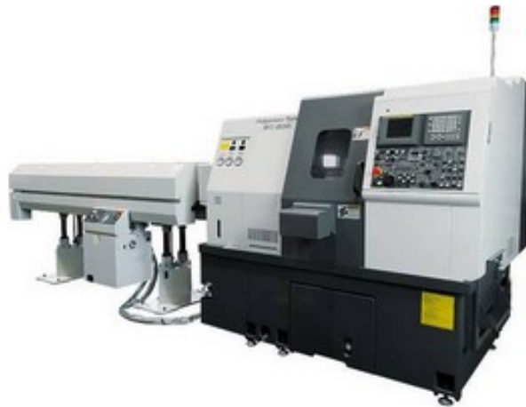
Slika 3.16 CNC tokarilica Nakamura AS-200 [15]
