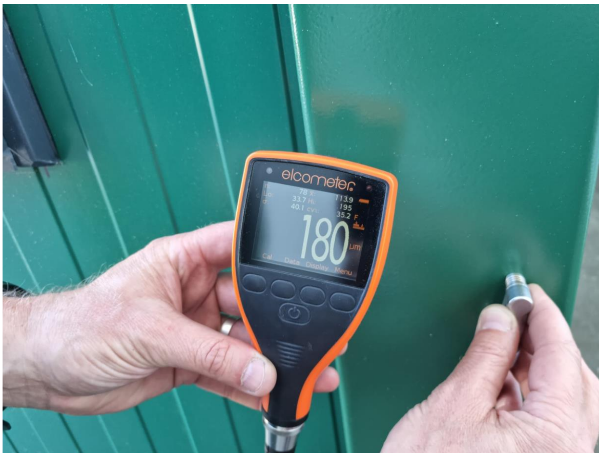
Slika 8.12 Mjerenje debljine premaza na kontejneru
