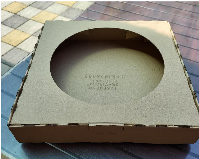
Slika 5.21 Kutija nakon savijanja
