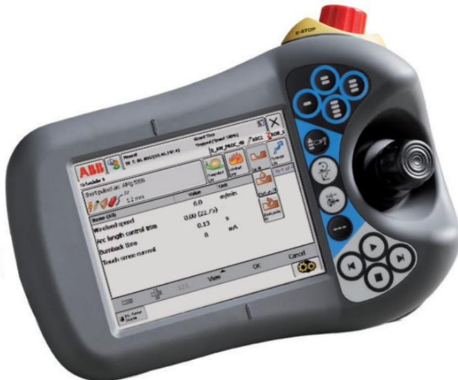
Slika 2.36. Upravljačka palica FlexPendant [9]
