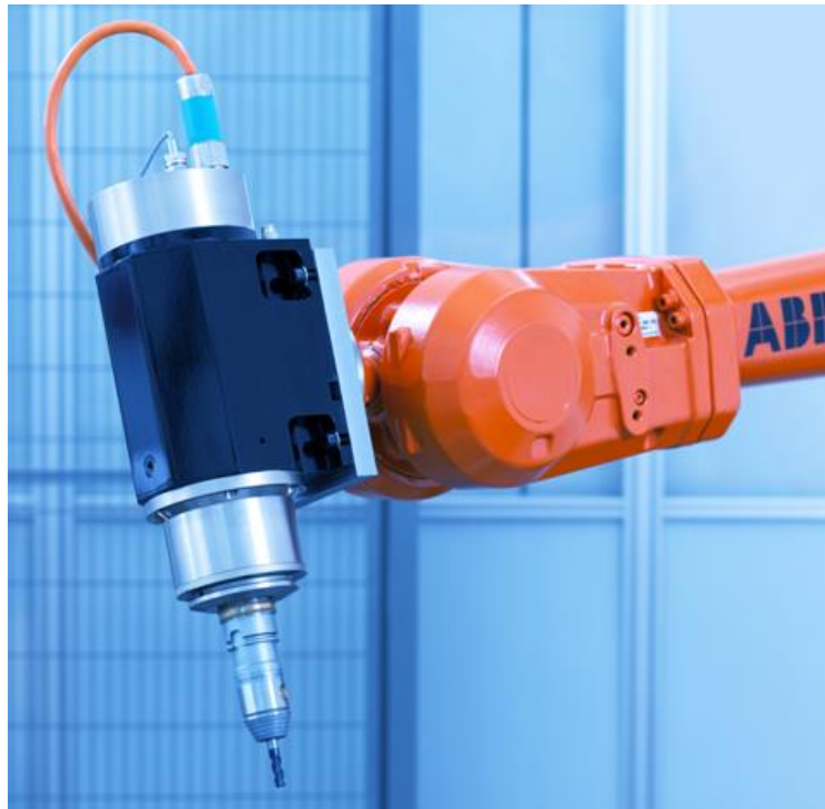
Slika 3.9. Primjer industrijskog glavnog vretena za robotsko glodanje
