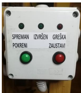
Slika 3.30: Prikaz sučelja automatske punilice za med
