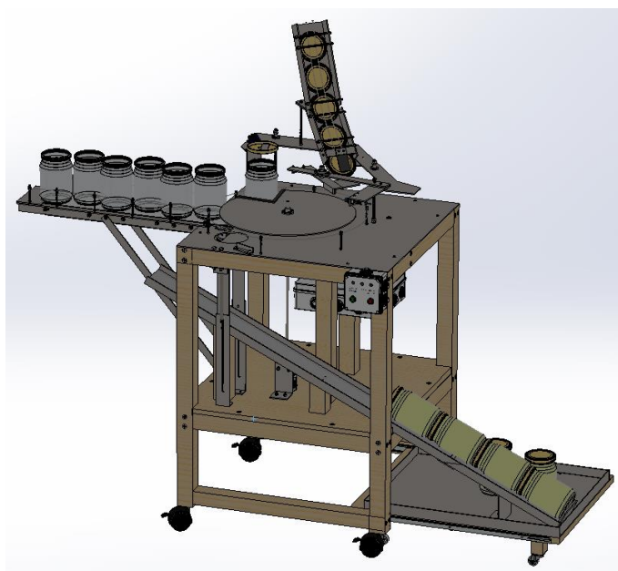
Slika 2.4: Prikaz 3D modela opremljenog glavnog stola
