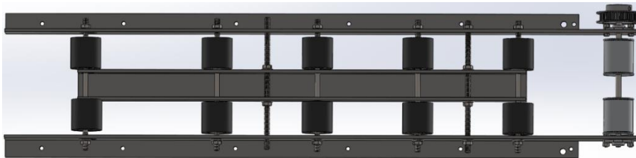
Slika 2.10: Prikaz 3D modela konstrukcije trakastog transportera
