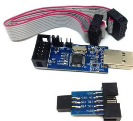
Slika 3.23: Prikaz korištenog programatora sa popratnim dijelovima [63]
