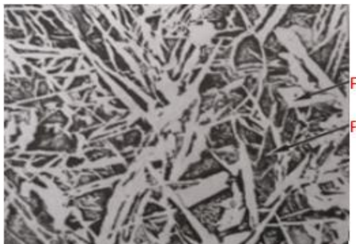
Slika 3.11. Mikrostruktura čeličnog lijeva [7]
