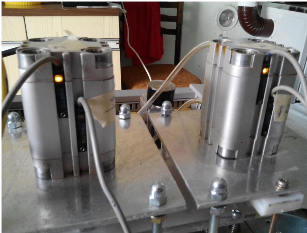
Slika 8.3. Magnetni senzori u radu
