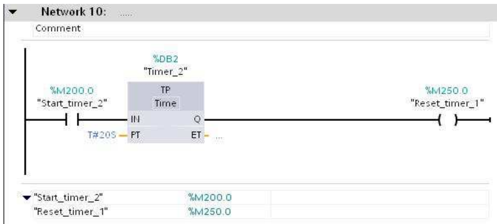
Slika 6.12: Zaustavljanje dozatora na namještenu vrijednost tajmera
