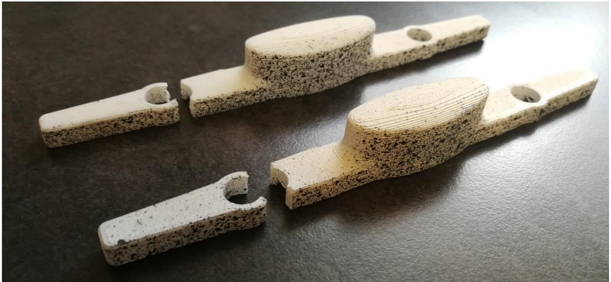
Slika 7.13: Lom na redizajniranoj kopči od Z-ULTRAT materijala.
