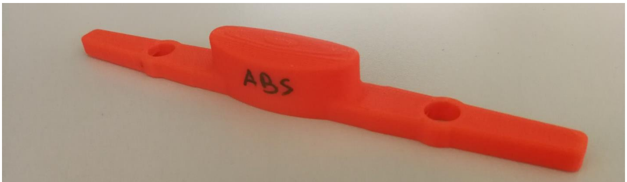
Slika 7.14: Prikaz odabrane redizajnirane kopče od Z-ABS materijala.
