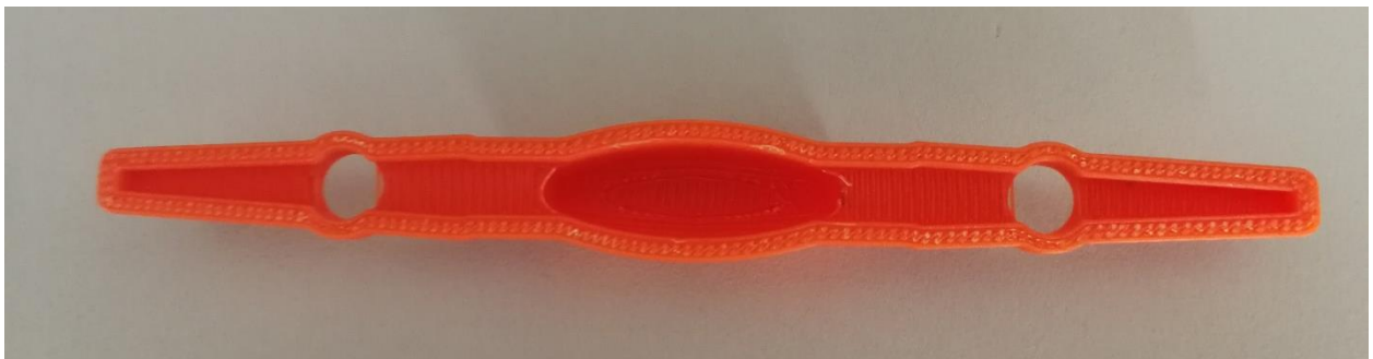
Slika 7.15: Pogled na unutrašnjost redizajnirane Z-ABS kopče.
