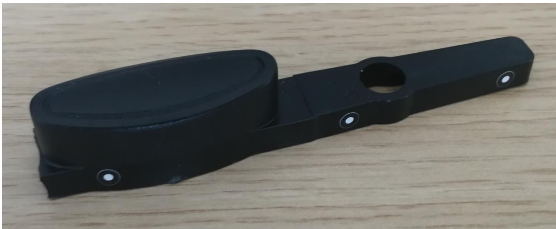
Slika 2.5: Fotografija oštećene plastične kopče ručke s referentnim točkama na površini.
