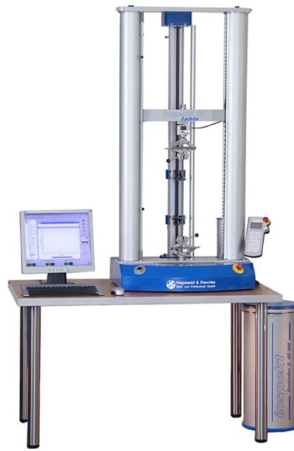
Slika 5.4: Prikaz korištenog uređaja Hegewald & Peschke Inspekt table 20 [21].
