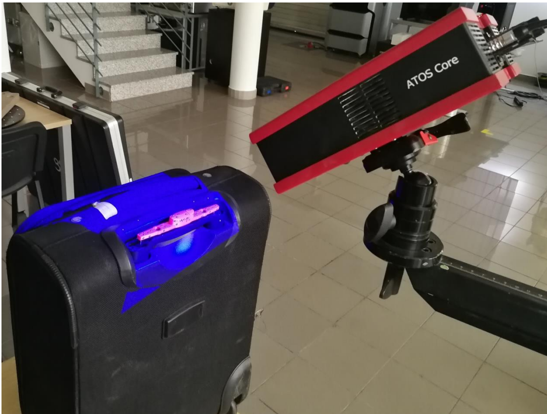
Slika 6.1: Postav za mjerenje progiba kopče na ručki ručne prtljage.
