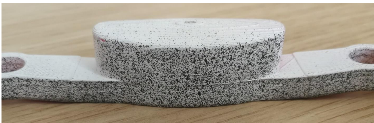
Slika 5.3: Stohastički uzorak na površini ispitnog uzorka.
