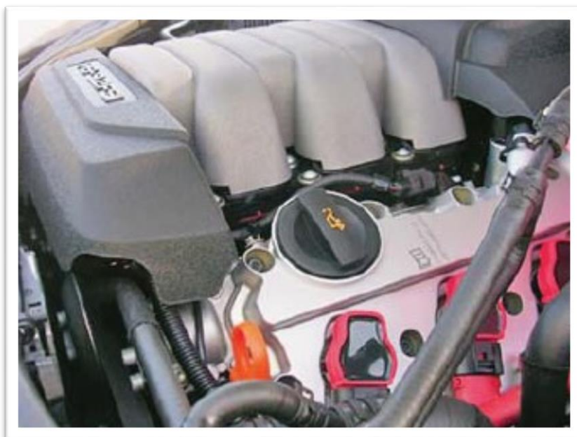
Slika 6.8: Poklopac glave motora Audi A8, 3.2 FSI [20]
