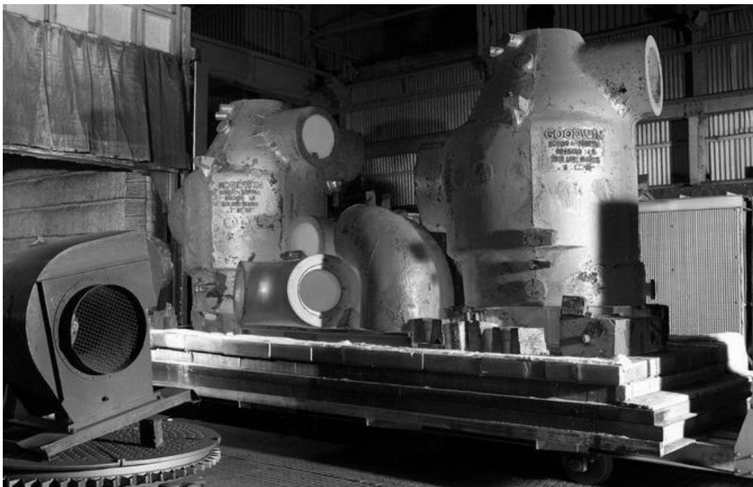
Slika 3.2: Hlađenje obratka do temperature okoliša [8]
