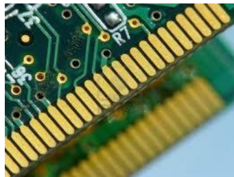
Slika 3.34: Zlato kao kontakt na tiskanoj pločici [30]
