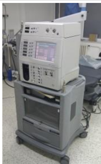
Slika 32. Accurus vitrekom za operacije na stražnjem segmentu oka
