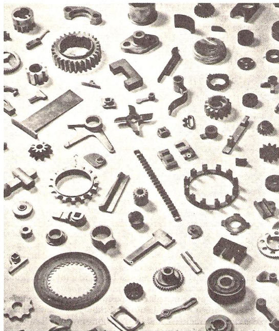
Slika 6.4 Strojni dijelovi proizvedeni sinteriranjem [69]
