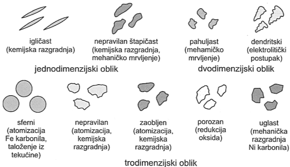
Slika 6.1 Oblici i grada čestica praha za sinteriranje [67]
