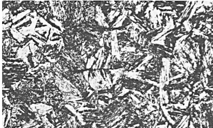
Slika 2.5 Martenzitna struktura ugljičnog čelika s 0,8 % C (povećanje 500x) [9]
