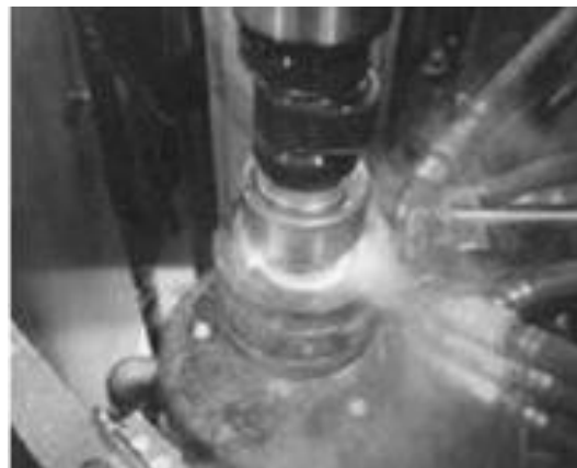
Slika 2.34 Rotacijsko indukcijsko kaljenje koljenaste osovine [14]
