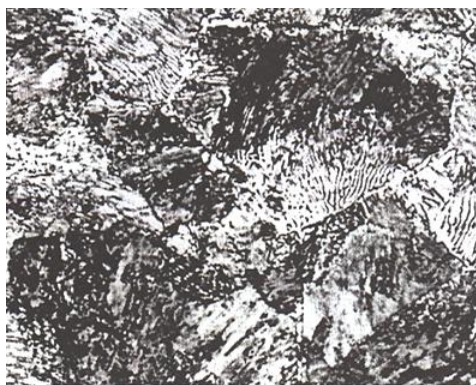
lamelarni (i mrežasti) oblik karbidnih čestica
