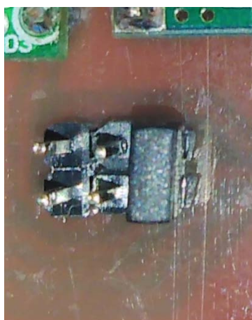
Slika 5.12 Položaj kratkospojnika za napon 6 – 30 VDC
