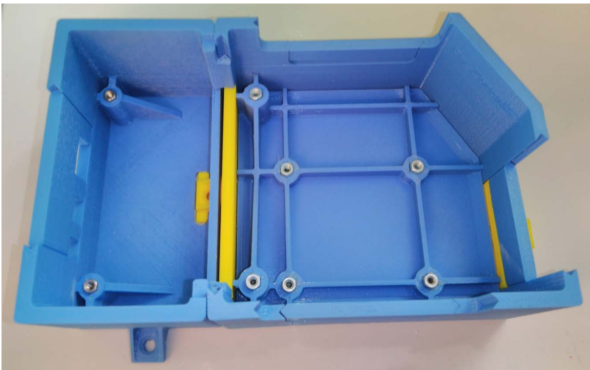
Slika 6.13 Kompletno kućište izrađeno 3D printanjem
