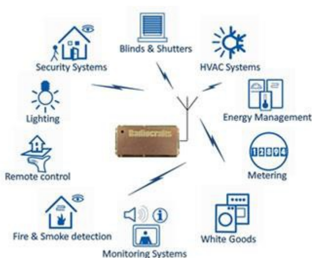
Slika 3.4. KNX sustav bežične komunikacije [5]
