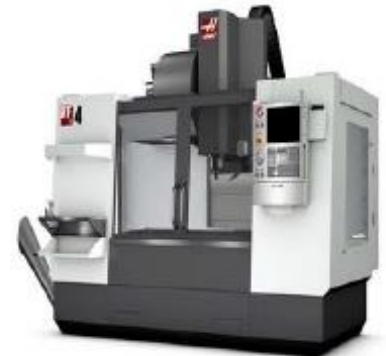
HAAS VF4, godina proizvodnje 2008. X=1.270, Y=508, Z=635
