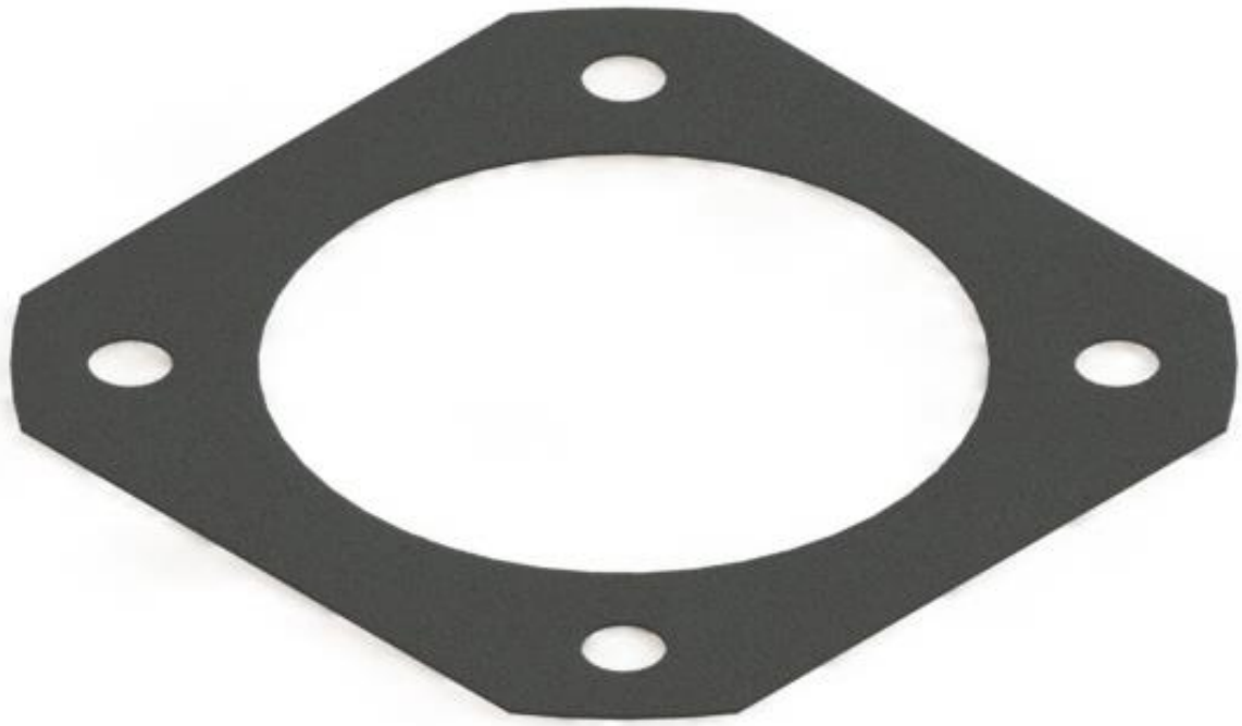
Slika 4.59 Renderirani (foto-realističan) 3D transparent model brtve pročištača PY-100.10
