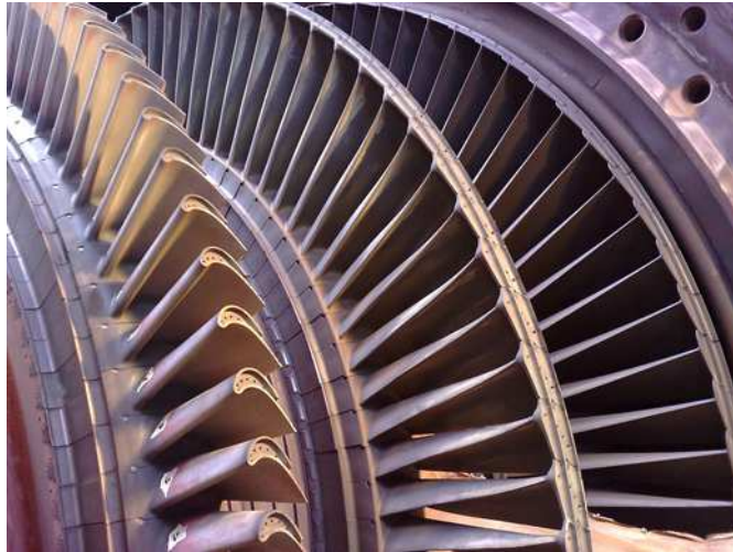
Slika 2.10 Lopatice plinske turbine [10]
