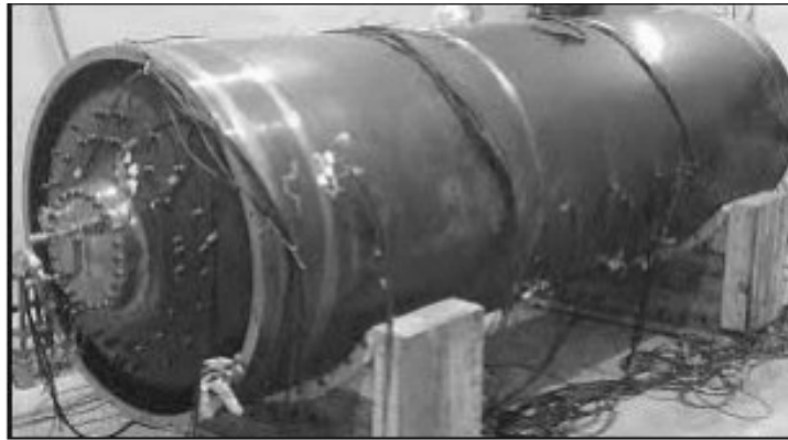
Slika 2.16 Kućište raketnog motora izrađenog od MARAGING čelika [6]
