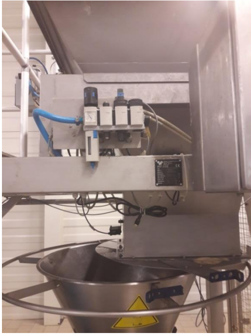
Slika 7.25. Pneumatski razvod za rad porcionika
