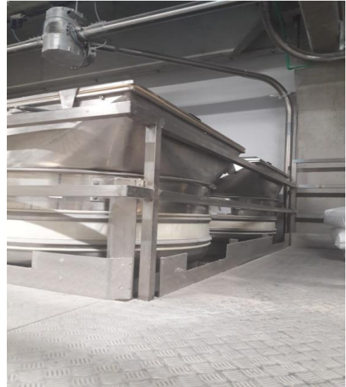
Slika 7.9. Silos za sirovine sa pripadajućom pneumatskom skretnicom za pojedino dozirno mjesto
