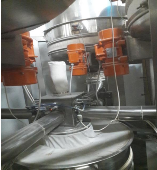
Slika 7.8. Silosi za sirovine sa otresačima
