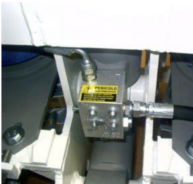
Slika 7.17. Sigurnosni ventil za podizanje glave hidrauličnog cilindra
