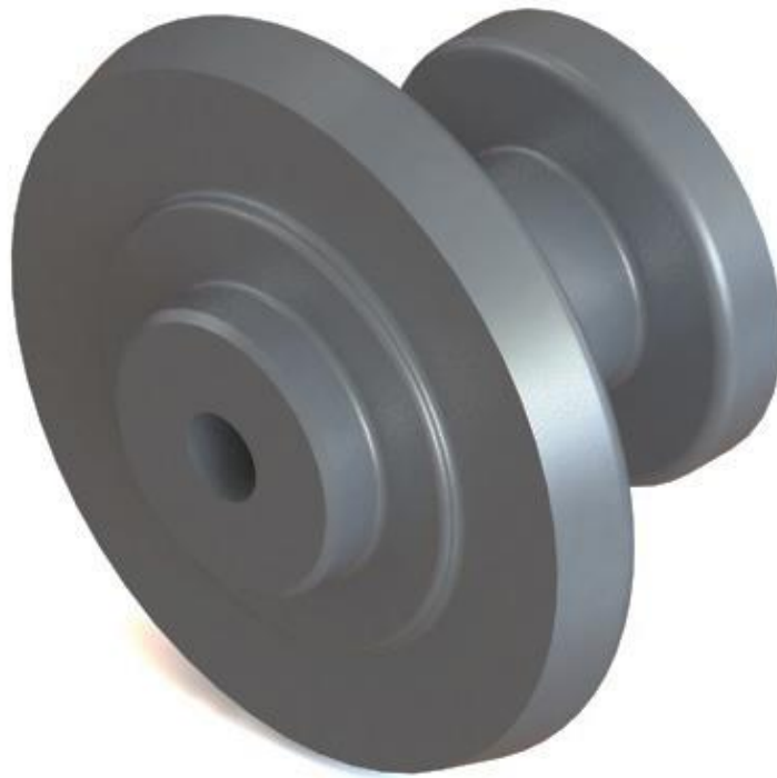
Slika 6.85. Renderirani (foto realističan) prikaz 3D modela klipa ( SolidWorks - Ordered Technology )
