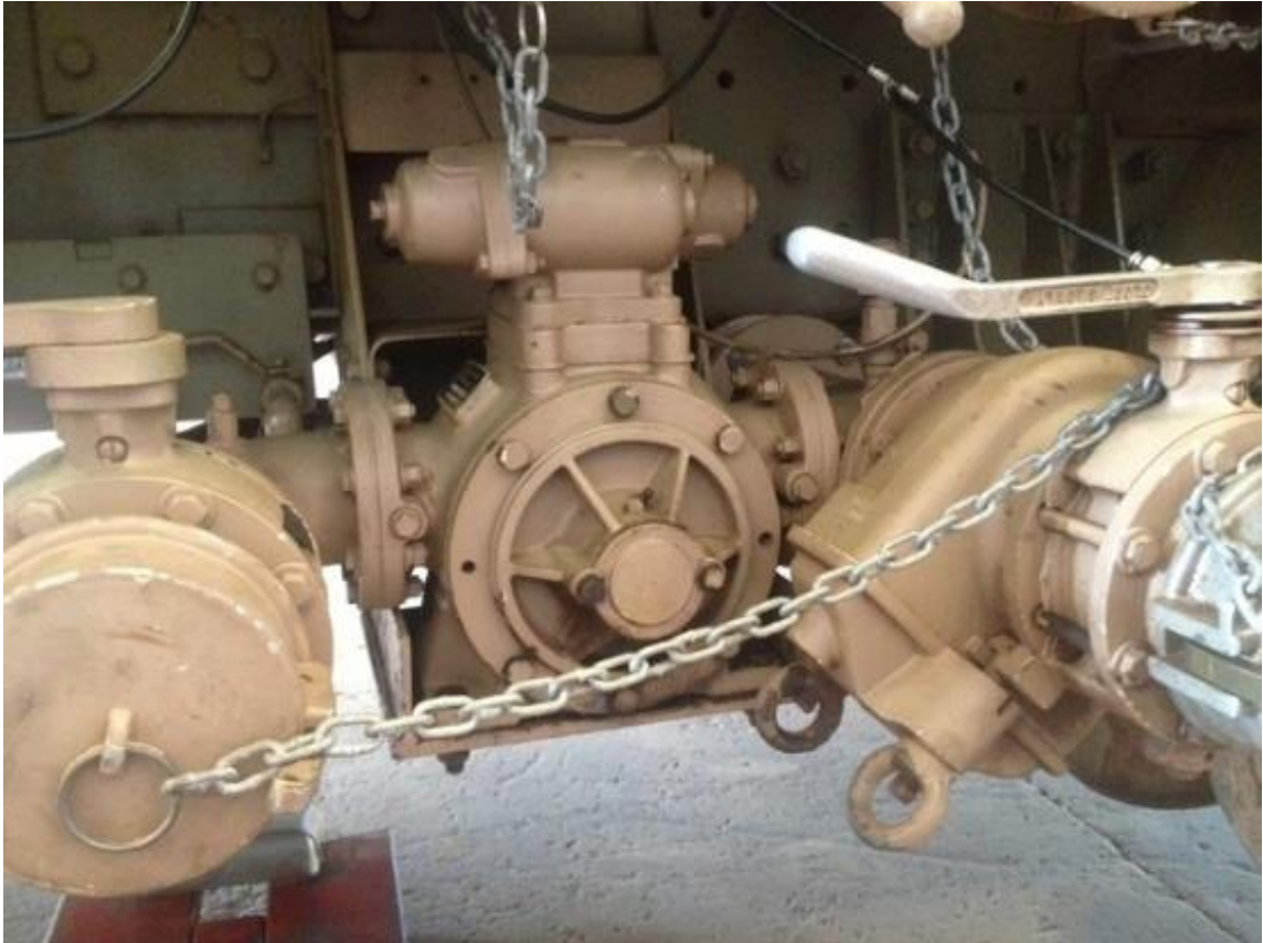
Slika 2.4. Primjena krilne pumpe na kamionu - cisterni [6]
