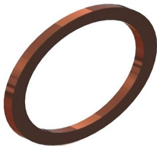
Slika 6.125. Renderirani (foto realističan) prikaz 3D modela zaptivač-a ( SolidWorks - Ordered Technology )
