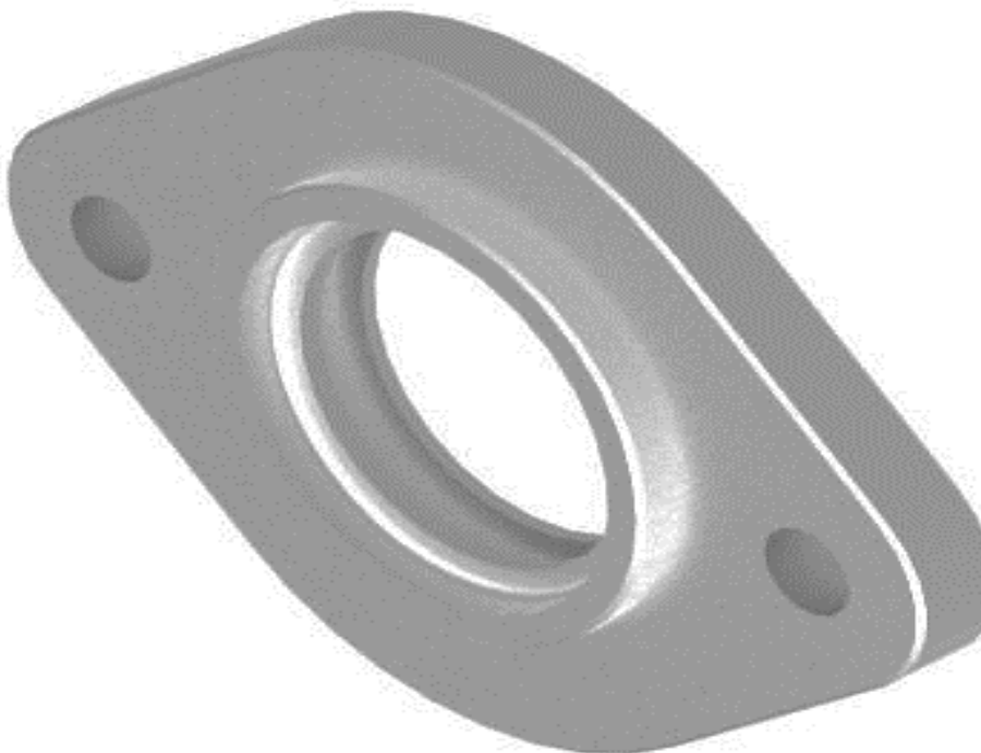
Slika 6.116. Renderirani (foto realističan) prikaz 3D prednjega poklopca ( SolidEdge ST8 - Synchronous Technology )
