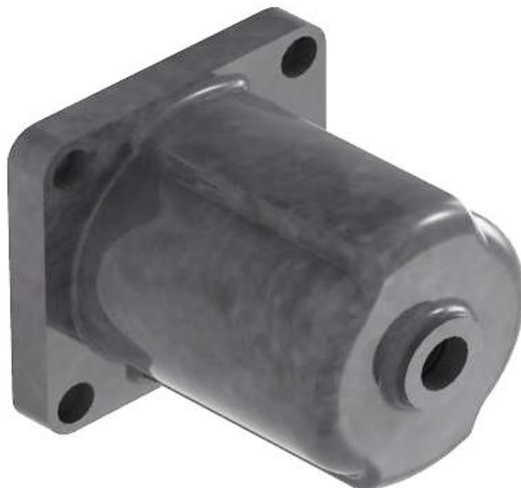
Slika 6.108. Renderirani (foto realističan) prikaz 3D modela poklopca ventila ( SolidEdge ST8 - Synchronous Technology )
