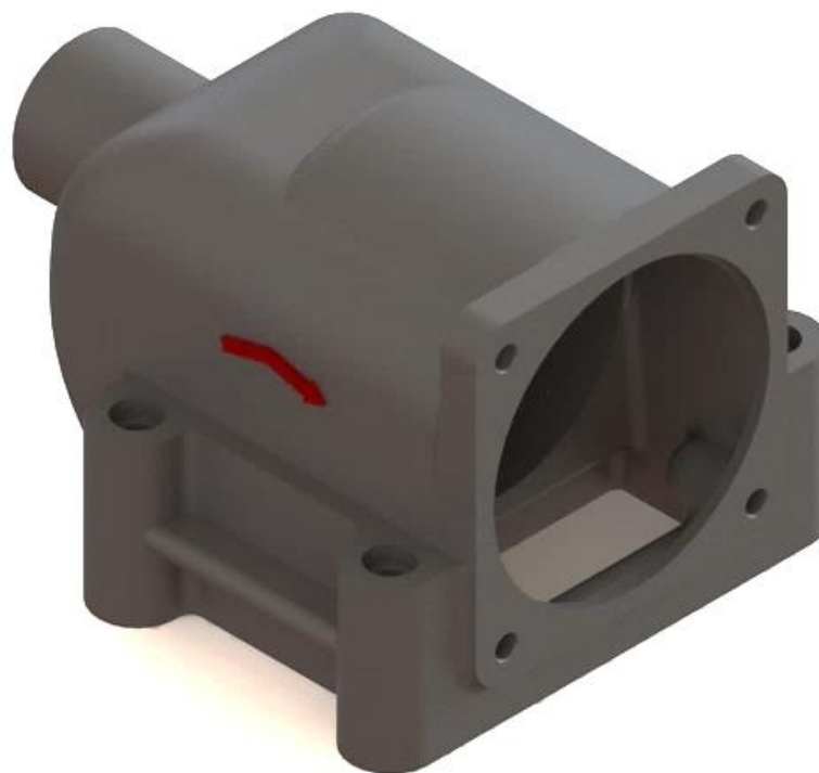
Slika 6.53. Foto realistični prikaz 3D modela kućišta ventila krilne pumpe (eng. Final Render ) u programskom alatu SolidWorks – Ordered Technology
