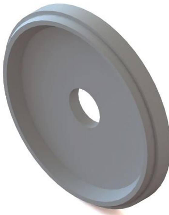
Slika 6.87. Renderirani (foto realističan) prikaz 3D modela čepa ( SolidWorks - Ordered Technology )
