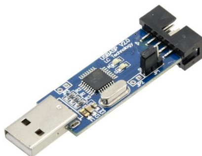
Slika 7.2. Prikaz USBasp programatora [6]
