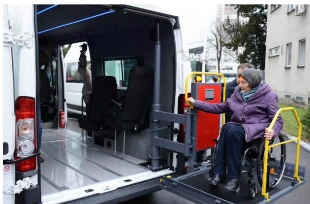
Slika 1.7.2. Kombi vozilo s podiznom platformom
