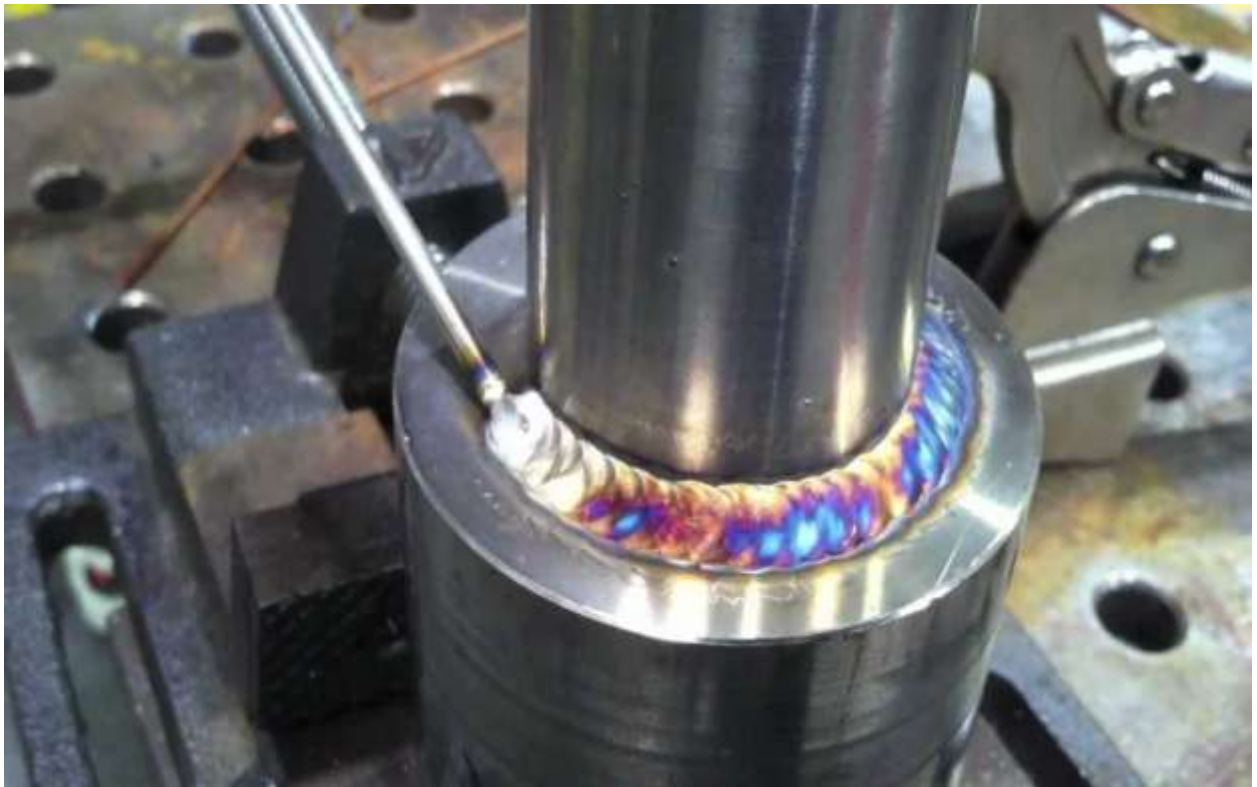
Slika 6.5. Zavarivanje WIG postupkom [12]
