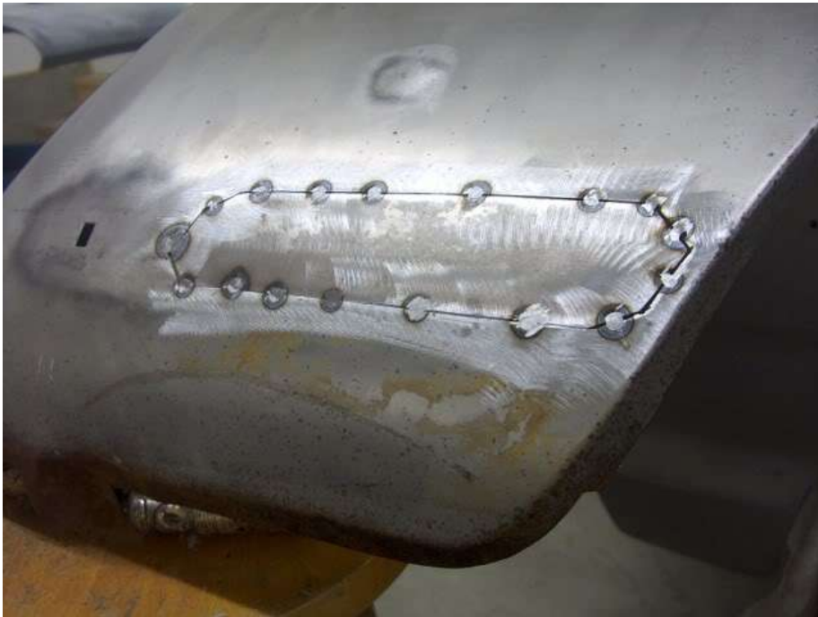
Slika 6.1. Točkasto zavareni spoj [8]
