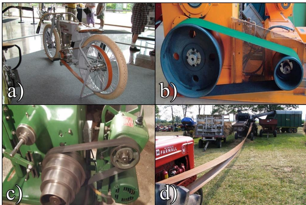
Slika 4.6. Primjeri korištenja plosnatog remena, a) završni prijenos starog motocikla; b) prijenos sa elektromotora; c) stepenasti prijenos stroja; d) prijenos pogona s traktora na kombajn [15,16,17,18]
