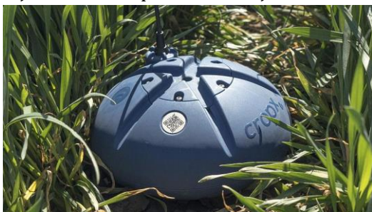
Slika 4. CropX senzor Izvor: Eastern Peak, 2022.
