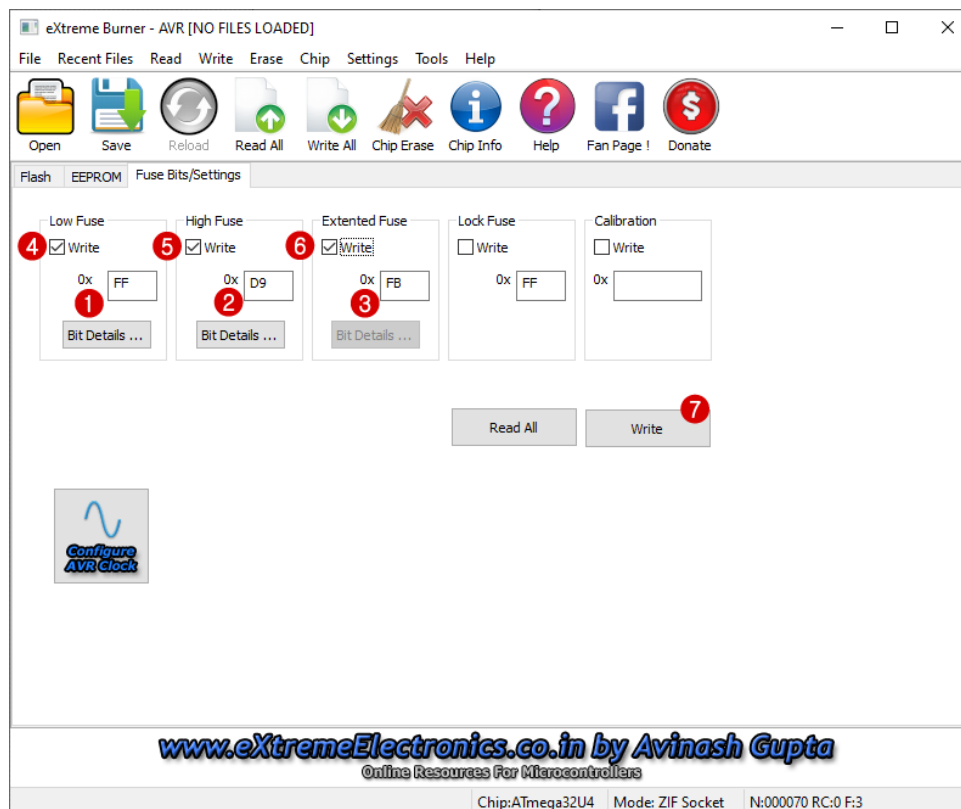
Slika 3.14: Softver eXtreme Burner - AVR - podešavanje Fuse bitova
