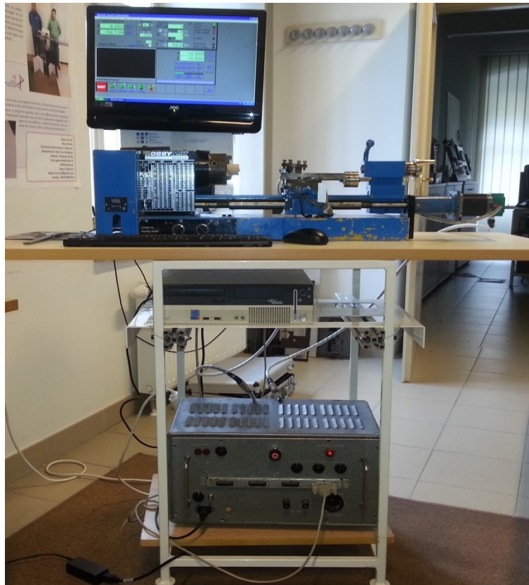
Slika 2.10 Tokarilica Hobbymat MD65 sa upravljanjem
