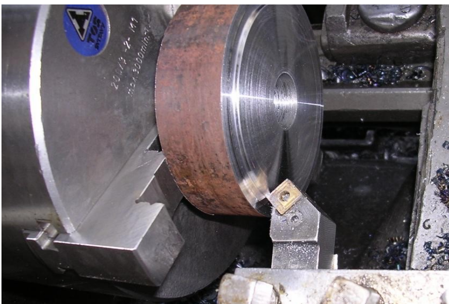
Slika 2.4 Poprečno plansko tokarenje [7]
