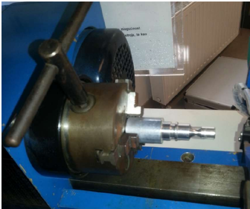
Slika 4.3 Stezanje predmeta obrade na Steznu glavu
