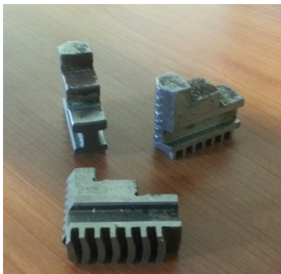
Slika 2.13 Prikaz čeljusti stezne glave
