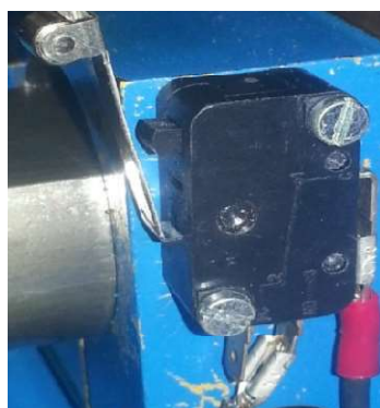
Slika 2.32 Mikroprekidač na CNC tokarilici HobbyMat MD65
