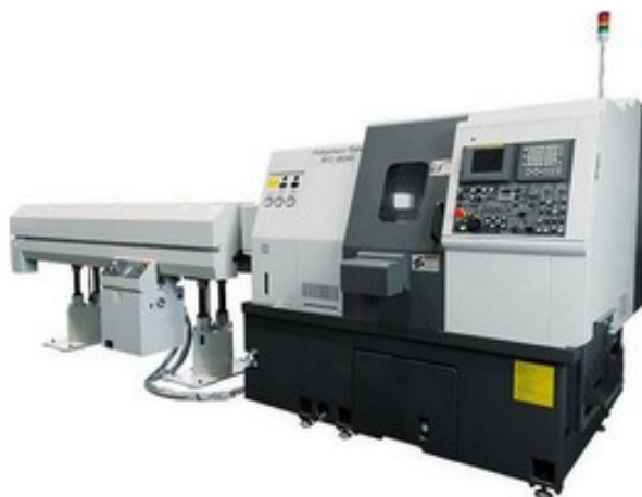
Slika 3.16 CNC tokarilica Nakamura AS-200 [15]
