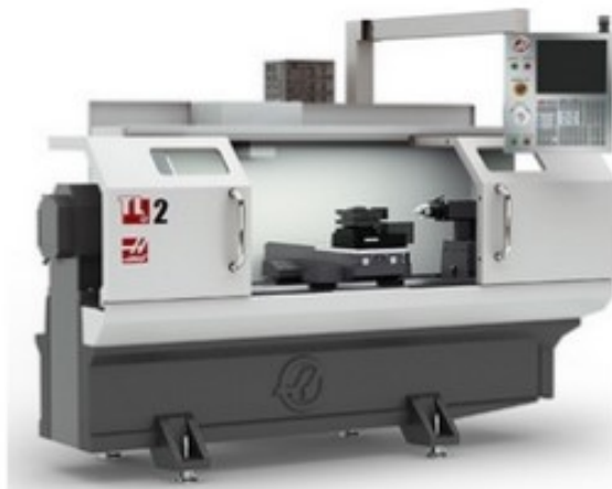
Slika 3.12 CNC tokarilica Haas TL-2 [15]
